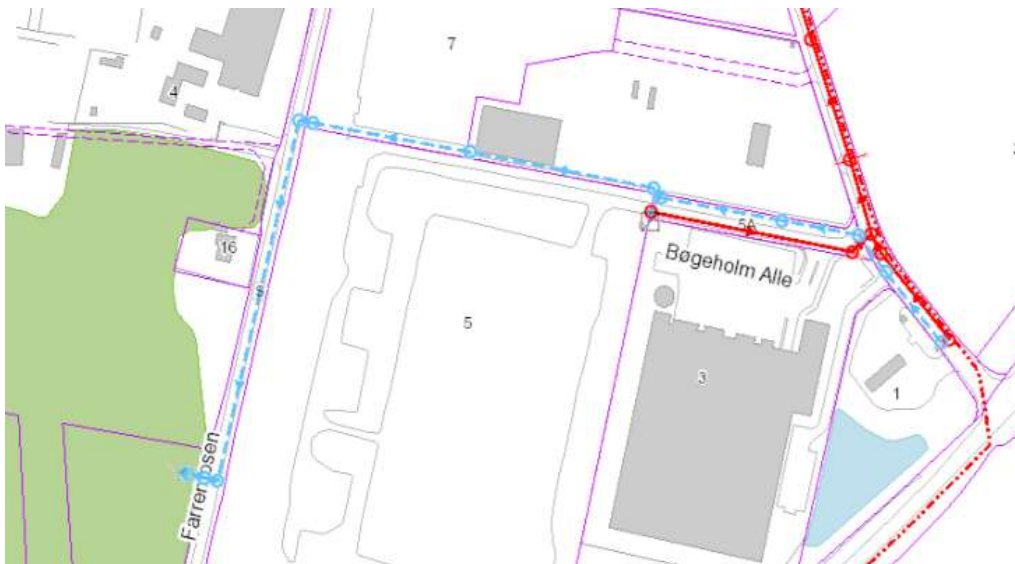
Figur 2. Novafos' regnvandsledning til forsyning af VasNOE2 med udløb til Faremosen mosen.
